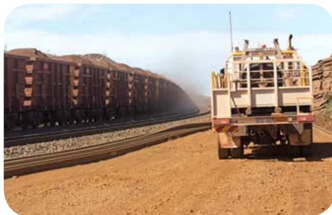
De extremt tunga malmtågen sliter hårt på både spår och ballast.
