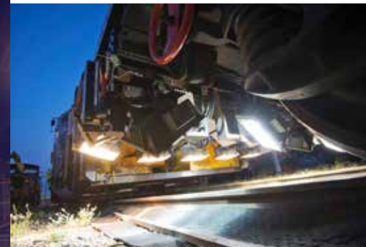
På undersidan av Hedwig sitter ett antal strålkastare som lyser upp spåren för att förbättra bildkvaliteten.
