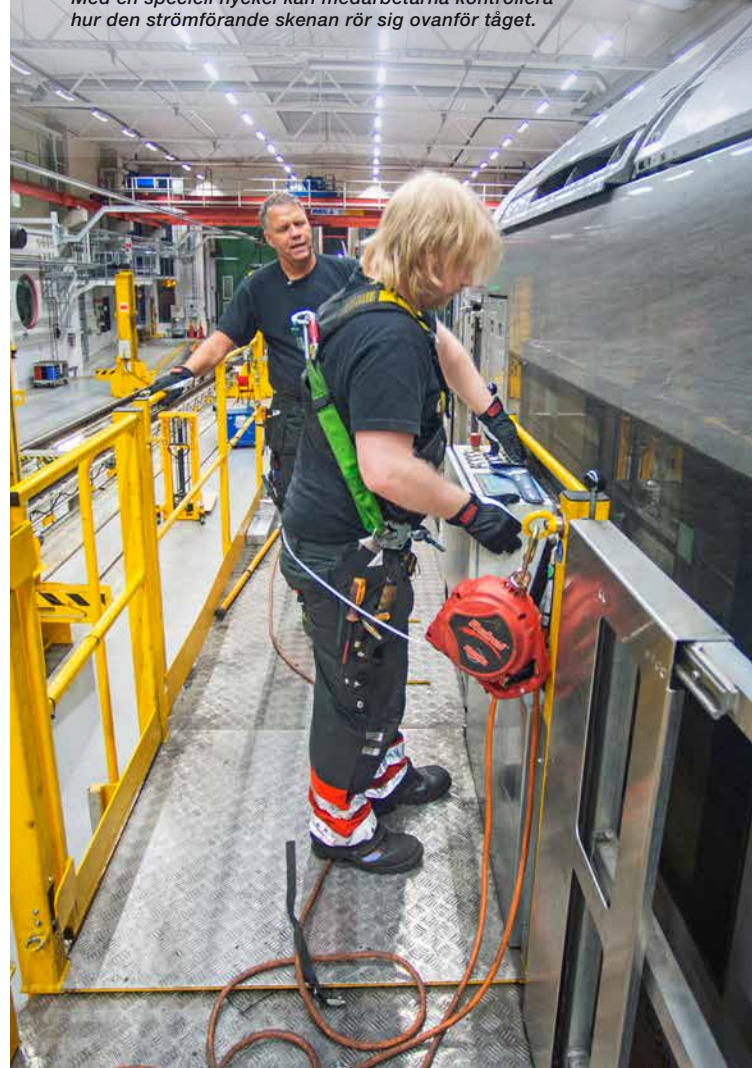
Med en speciell nyckel kan medarbetarna kontrollera hur den strömförande skenan rör sig ovanför tåget.
